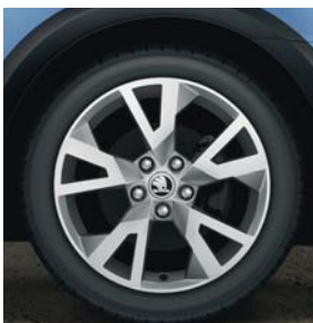
Die Leichtmetallfelge POLAR 7,0J x 17" mit 225/50 R17 Bereifung.
